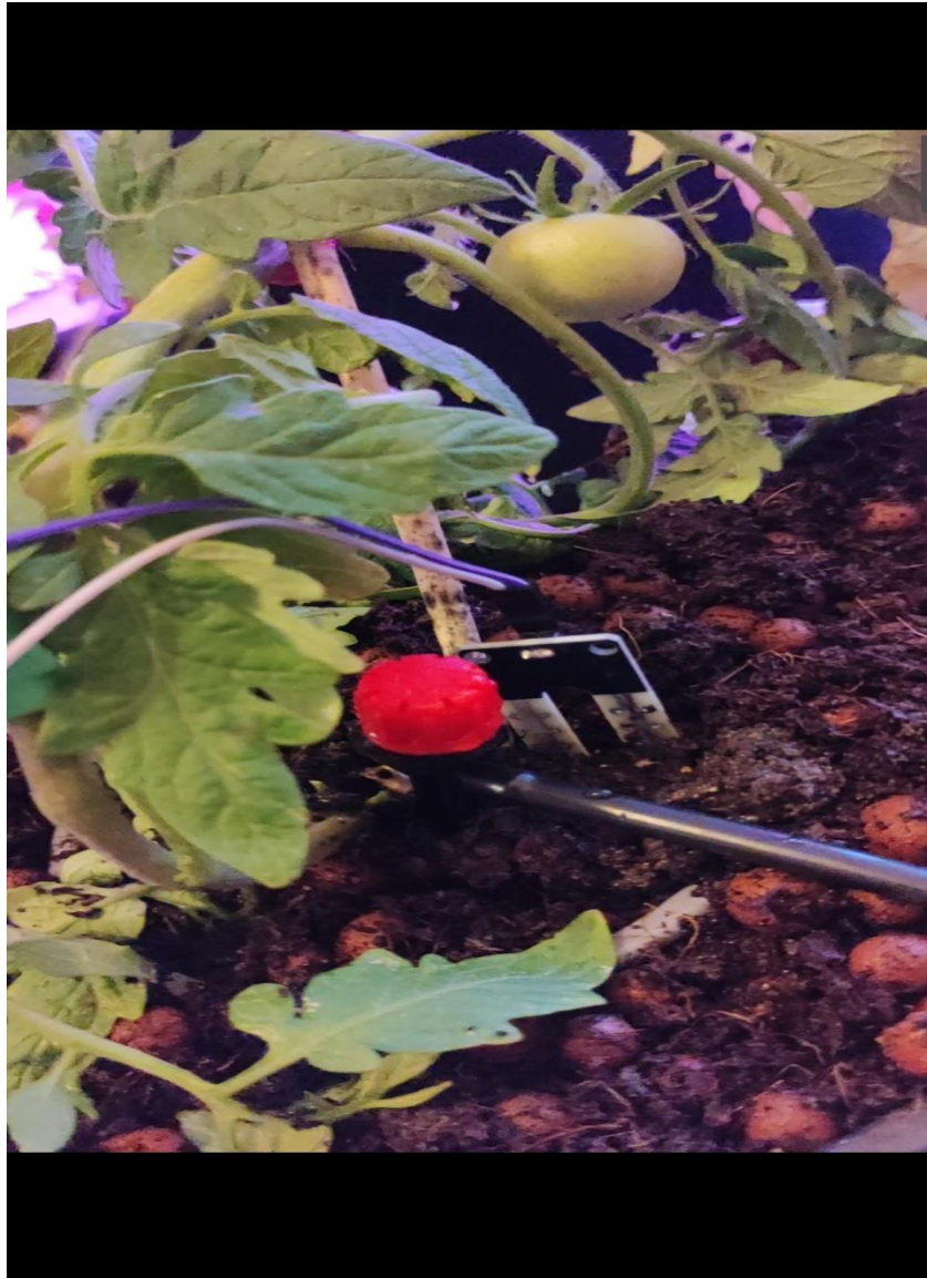
Εικόνα 43: Αισθητήρας υγρασίας (Soil humidity sensor)
