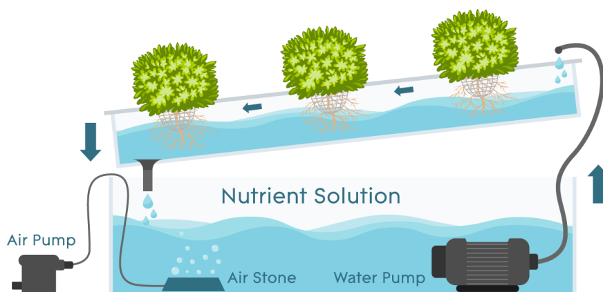
Εικόνα 11: Αρχιτεκτονική συστήματος NFT
