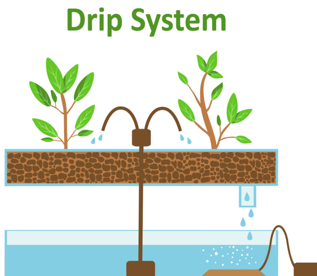
Εικόνα 9: Αρχιτεκτονική συστήματος άρδευσης σταγόνας
