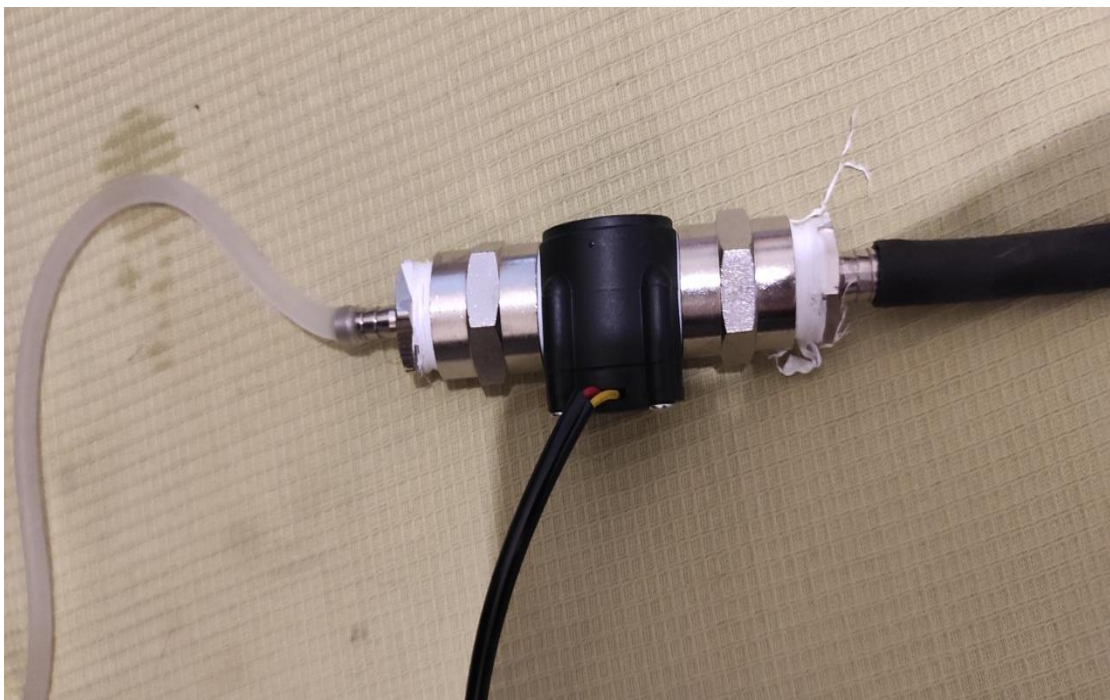
Εικόνα 37: Είσοδος και έξοδος αισθητήρα ροής
