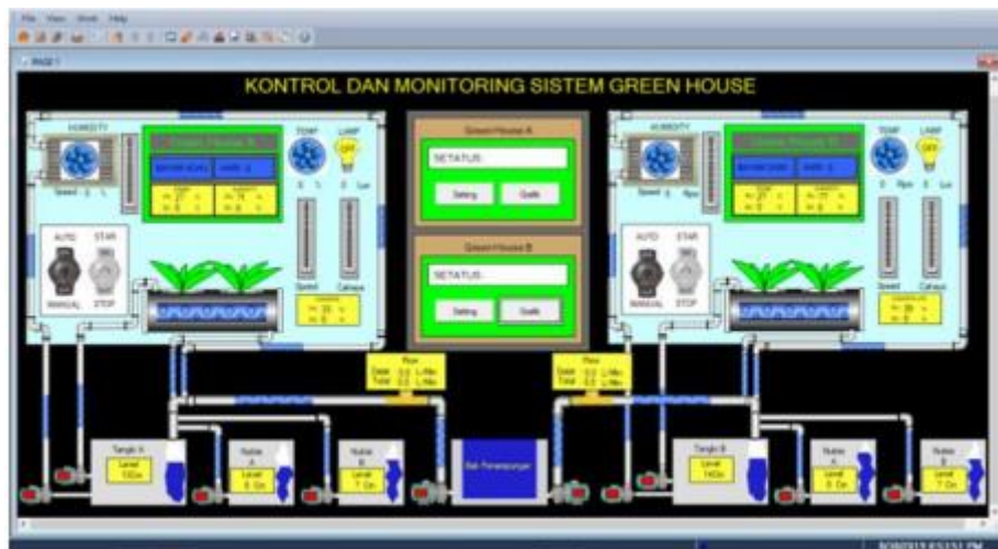
Εικόνα 3: Σύστημα ελέγχου SCADA σε ένα θερμοκήπιο
