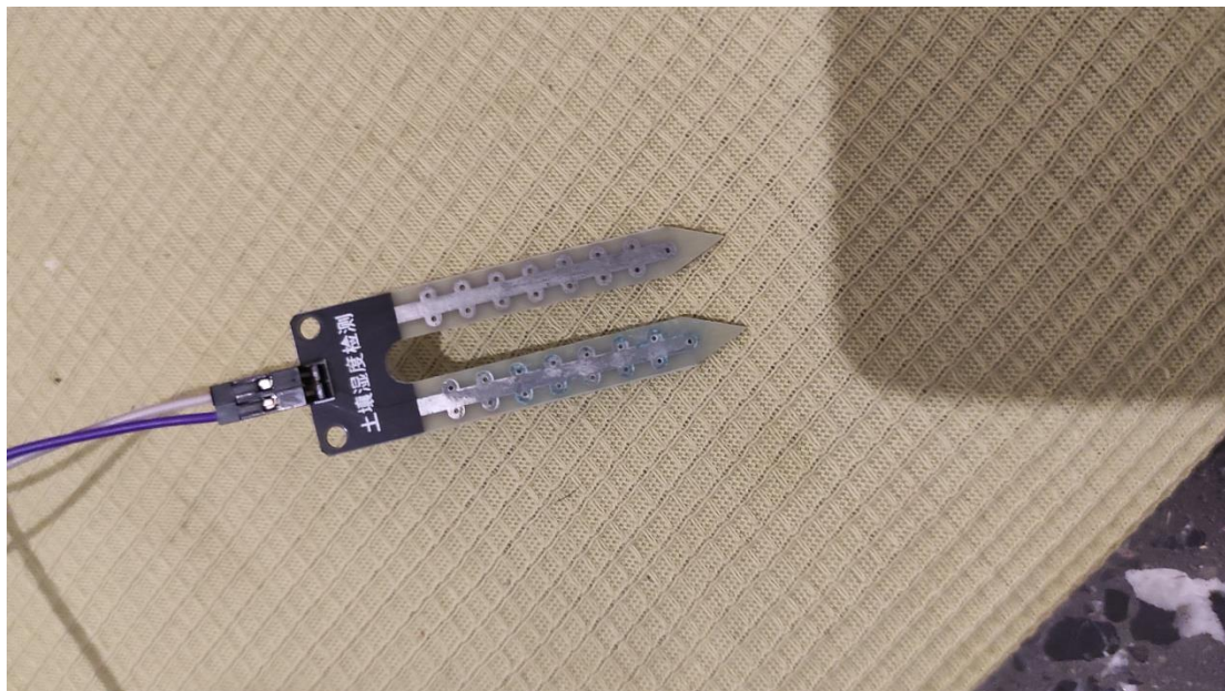
Εικόνα 49: Αισθητήρας υγρασίας εδάφους (Soil moisture sensor)
