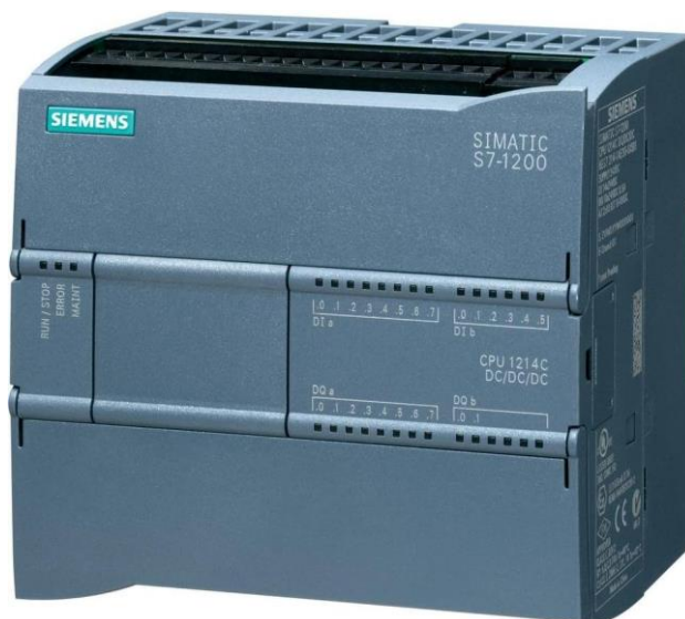
Εικόνα 2: Ο προγραμματιζόμενος λογικός ελεγκτής (PLC)
