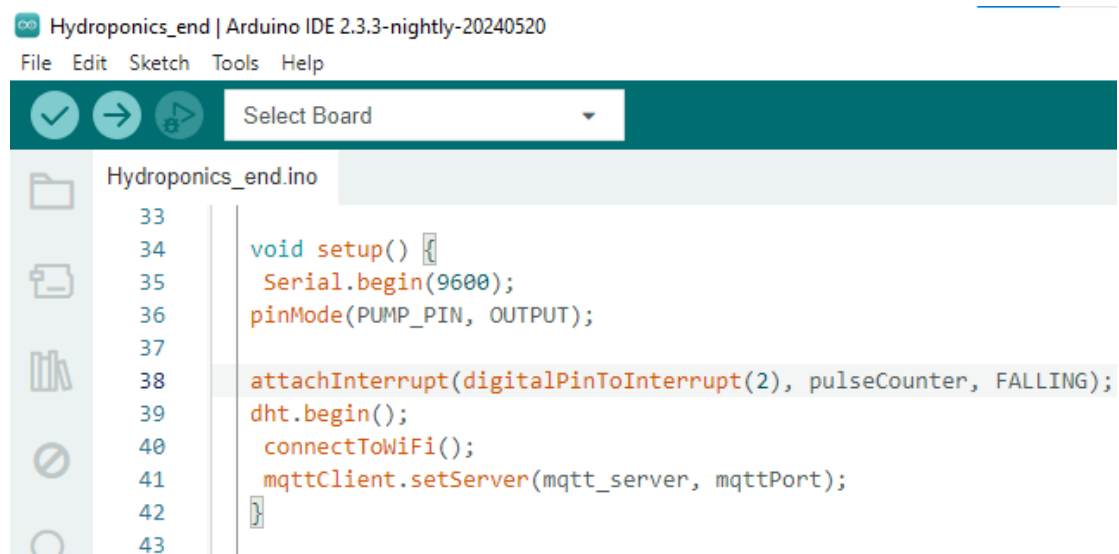
Εικόνα 52: Η συνάρτηση void setup();
